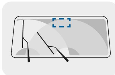
■ **Étape 2.** Sélectionnez la position de la caméra. Celle-ci doit être installée au centre du pare-brise. La position recommandée est au-dessus du rétroviseur intérieur et dans la zone couverte par les essuie-glaces.
