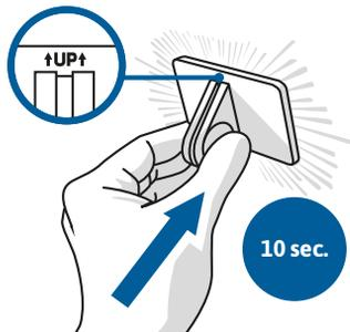
■ **Étape 5.** Fixez le support horizontalement sur la zone nettoyée. Assurez-vous que le côté denté soit orienté vers la droite. Appuyez sur le support pendant 10 secondes afin d'éviter la présence de bulles d'air entre le support et la vitre.
