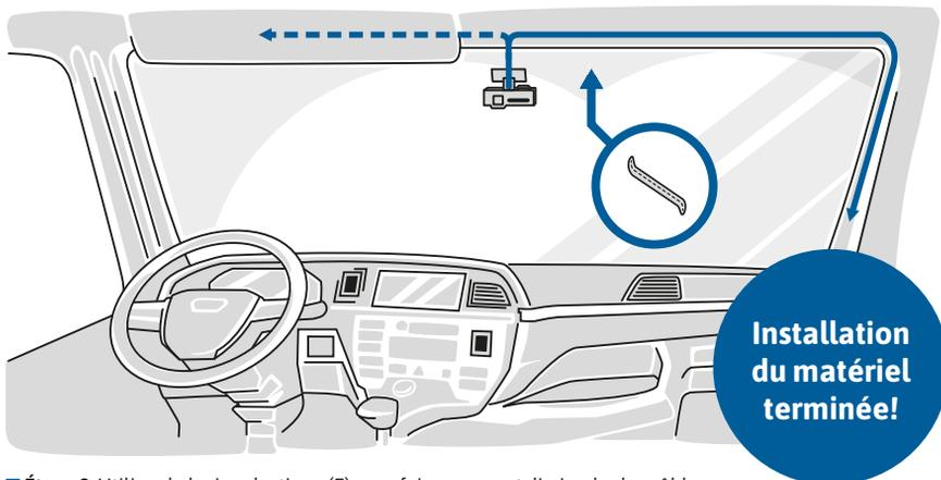
■ **Étape 9.** Utilisez le levier plastique (E) pour faire passer et dissimuler les câbles sous la garniture de toit et le montant de la cabine. Choisissez le chemin le plus adapté en fonction de l'emplacement du port FMS. Branchez les deux extrémités des faisceaux (connecteur cylindrique) de la caméra et du faisceau FMS.
