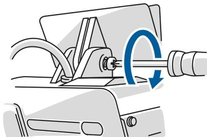
■ **Étape 7.** Utilisez un tournevis cruciforme PH2 pour visser la vis de serrage (C) dans le sens des aiguilles d'une montre. Serrez-la après avoir ajusté la caméra d'avant en arrière afin de garantir qu'elle soit en position horizontale. Assurez-vous que l'unité principale soit bien fixée et ne bouge pas.
